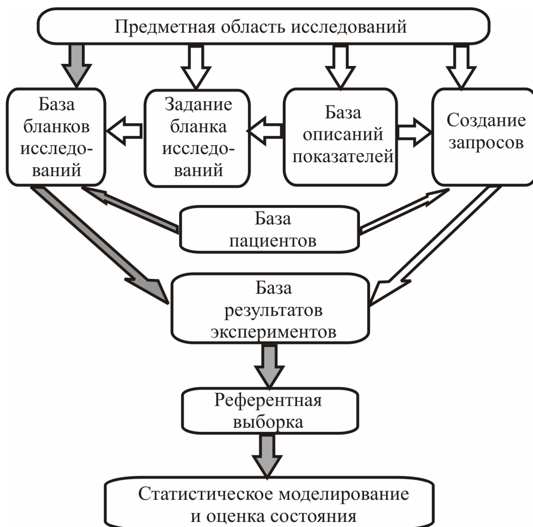
Рис. 1. Структурная схема информационной системы. Темными стрелками обозначены потоки данных, светлыми – потоки описаний.
